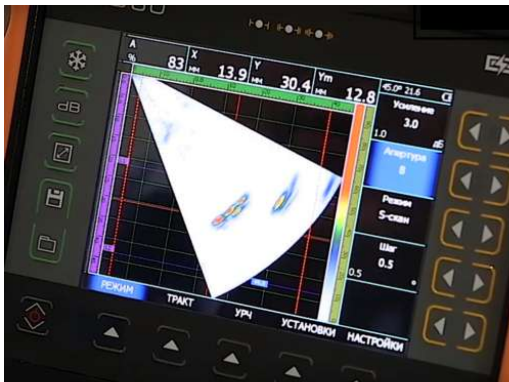
Рис. 4. Ультразвуковой контроль детали «Фланцевая крышка подшипника»
