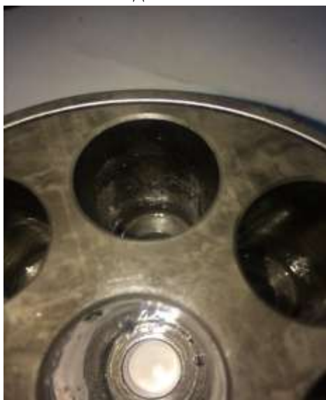
Рис. 2. Следы износа на распределительном диске
