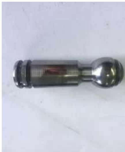
Рис. 3. Следы износа на поршне
