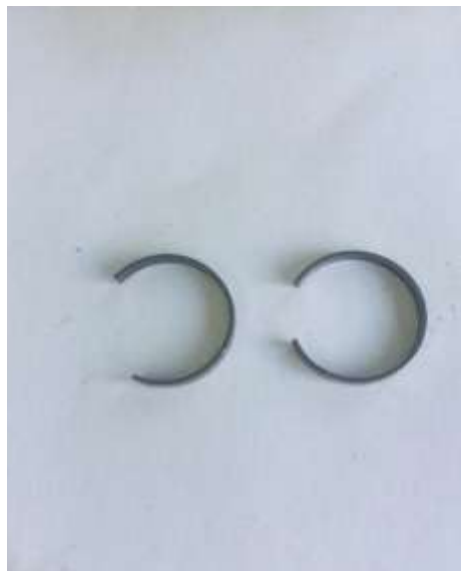
Рис. 5. Поломка колец (слева – дефектное, справа – нормальное)
