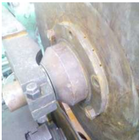
Рис. 2. Изнашиваемый узел соединения подшипников скольжения
