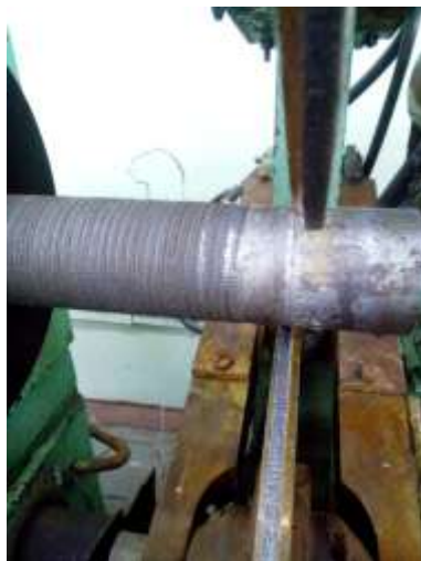
перекос сварочных роликов
