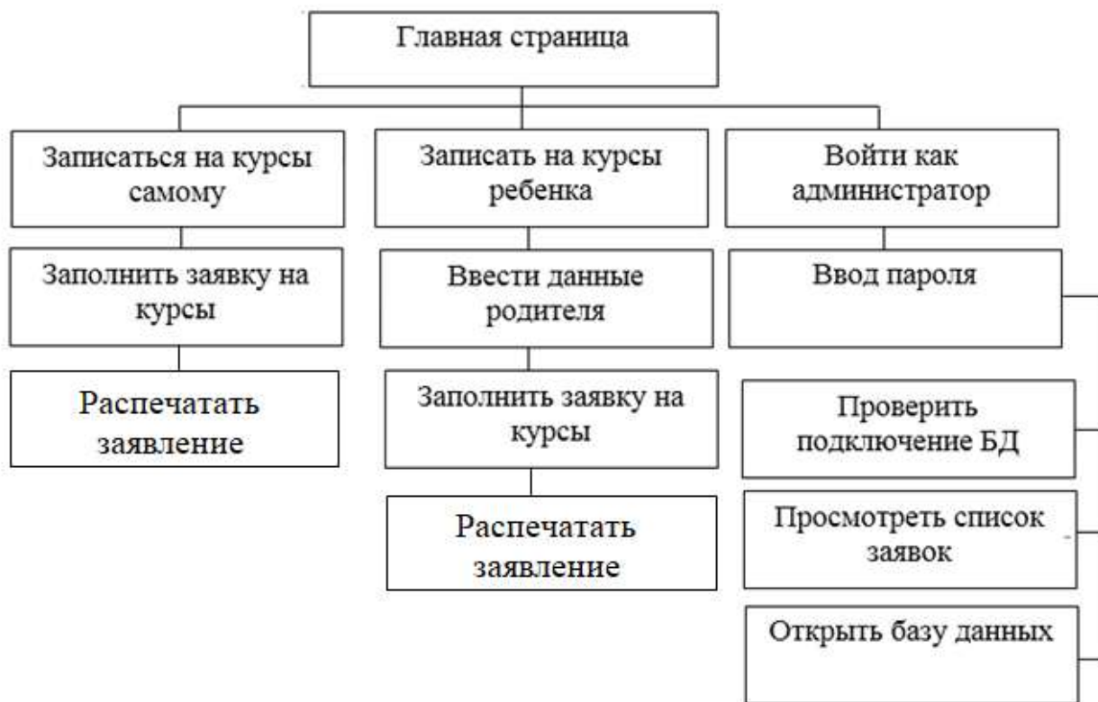
Рис. 2. Структура системы записи на курсы скорочтения
